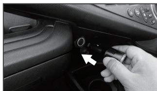
⑥シガーケーブルと冷却ユニットケーブルを繋いで、シガーソケットに付属の電源ケーブルを差し込み、スイッチON。インジケータランプの点灯を確認したら取付完了です。
